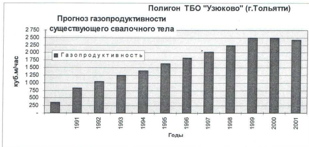
Рис.2 – Прогноз газопродуктивности существующего свалочного тела на период 1991-2001 гг.
